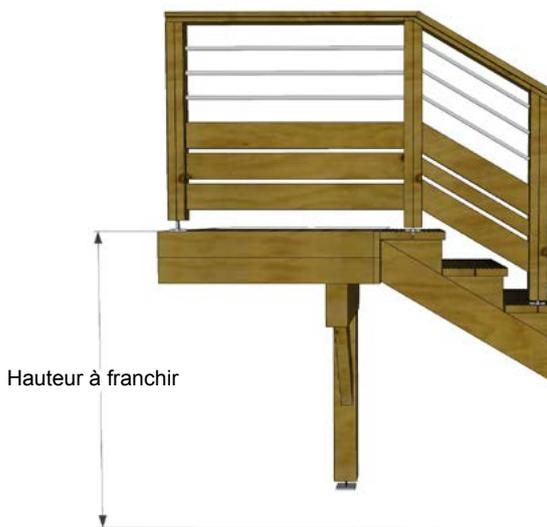
**2** MESURER LA LARGEUR ET LE GIRON - Les mesures standards (giron 17/29,5 cm)
